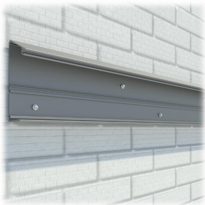
Wandprofil Montage Löcher/Anbringung im 50-70cm Abstand
