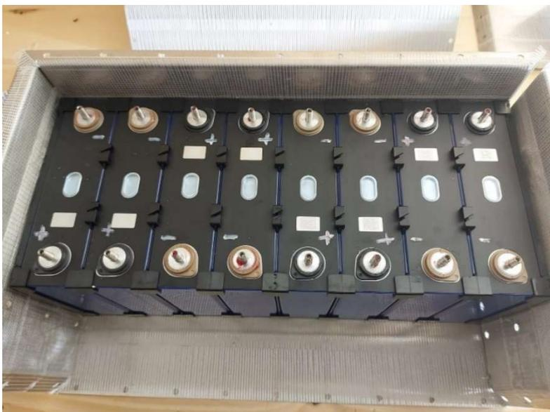
6. Batterien mit Klemmblech befestigen (Kantenschutz beachten!)
