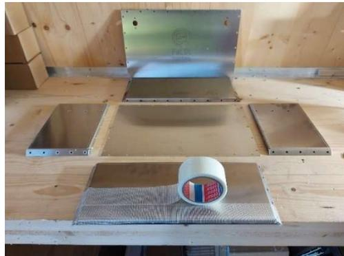
2. Gehäuse zusammenschrauben (bei Seitenteilen links/rechts beachten!!)
