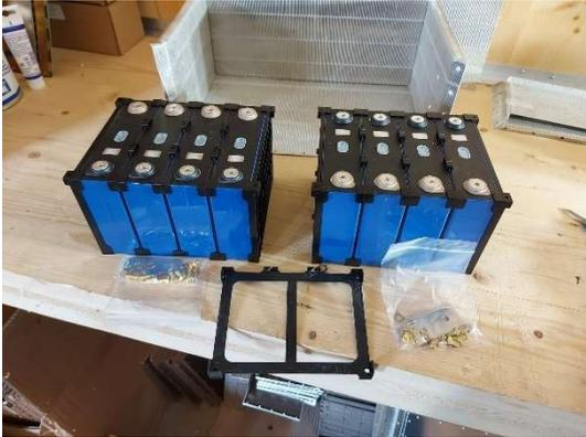
4. Überstand der seitlichen Distanzhalter absägen, damit das Batteriepaket in ihrer Breite in das Gehäuse eingesetzt werden kann
