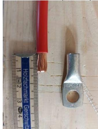
13. Kabelschuh aufpressen + Kabel mit Gewebefband umwickeln (ca. 10-20mm)
