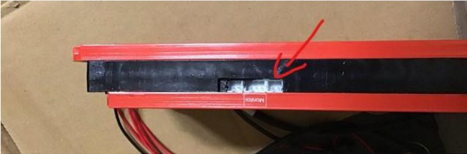
3. Balancer Kabel abstecken und am Stecker Spannungsreihe prüfen!
